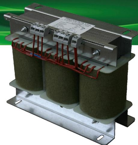
Trasformatori in cui non esiste una reale separazione elettrica tra avvolgimenti primario e secondario, consentono l'alimentazione di sistemi o macchine con tensione nominale diversa da quella di rete; con ingombri, pesi e costi ridotti rispetto ad un trasformatore tradizionale possono essere realizzati con più di due tensioni.
