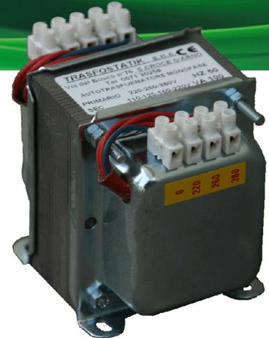
Trasformatori in cui non esiste una separazione elettrica tra avvolgimenti primario e secondario, consentono l'alimentazione di sistemi o macchine con tensione nominale diversa da quella di rete; con ingombri, pesi e costi ridotti rispetto ad un trasformatore tradizionale possono essere realizzati con più di due tensioni.
